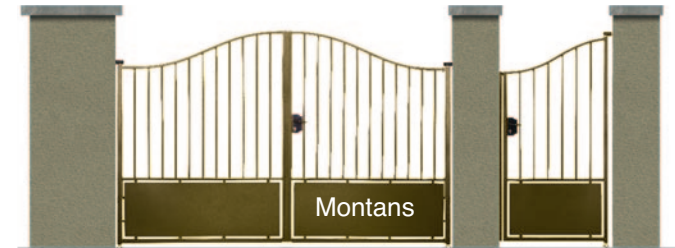
Cadre en tube 35x35x2, cintre en tube rectangle 35x20x2, barreaudage en tube rond Ø 17, soubassement en tôle plane de 2 mm, plat de battement.
