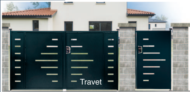
Cadre et montant en tube 40x40x2, remplissage en tôle plane de 2 mm d'épaisseur avec découpe Laser, plat de battement.
