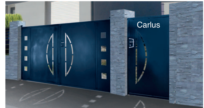
Cadre et montant en tube 40x40x2, remplissage en tôle plane de 2 mm d'épaisseur avec découpe Laser motif carré 120x120, plat de battement.
