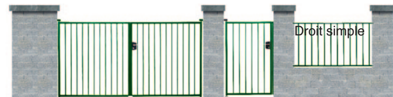
Cadre en tube 35x35x2, barreaudage en carré plein 14x14, plat de battement.
