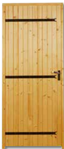
Porte de service standard (PSC) brochée ferrée par pentures et contre-pentures ouverture intérieure en 26 ou 32 mm
