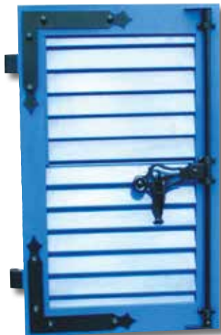
Volet à cadre assemblé 1/3 lames ajourées à l'américaine ou jointives 2/3 bas : panneau de remplissage
