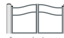
Traverse même forme pour portail 2 vantaux Chapeaux de gendarme ou Cintre
