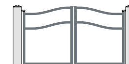
Traverse même forme pour portail 2 vantaux Chapeaux de gendarme ou Cintre
